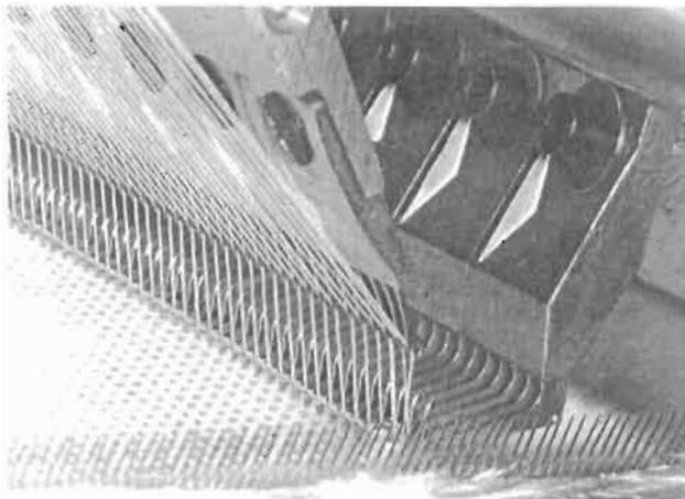
**Figure 2.30** Knit loop formation (courtesy of LIBA-Maschinenfabrik GmbH)
