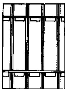
(a) 加筋层压板的轴压试验件简图
