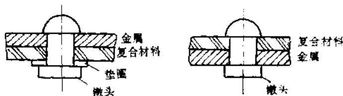
图 10.13 实心铆钉垫圈的使用
