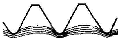
图 11.33 滚压成形的螺纹流线
