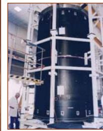
Composite LH<sub>2</sub> Cryotank
