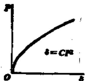
图 11-29. 例题 1. 非线性载荷-挠度曲线。
