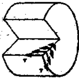
图 3-2. 圆杆中的纵向剪应力。
